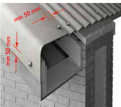
39 pav. Stauso kampo vėjalentės montavimas.
