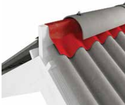
7 pav. Kraigas uždengtas pusapvaliu kraigu ir kraigo juosta – ventilavimo paviršius 1 bėginiame metre kraigo: lakštai B59 – 150 cm 2 , lakštai B65 – 255 cm 2 kiekvienam šlaitui.
