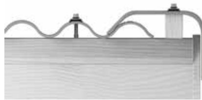
40 pav. Vėjalentės su lenkta briauna montavimas.
