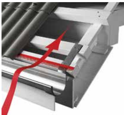
5 pav. Stogo karnizas – vėdinimo angų plotas viename tiesiniame metre: lakštai B59 – 120 cm 2 ; lakštai B65 – 200 cm 2 .
