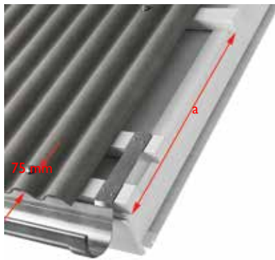
2 pav. Prie stogo karnizo tvirtinamo lakšto EUROFALA, atstumas nuo briaunos iki pirmojo tvirtinimo yra mažiausiai 75 mm.
